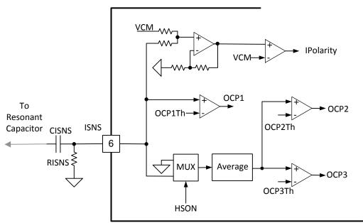
Figure 7-7. ISNS Block Diagram
